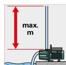
Hauteur maximale pour laquelle l'eau peut être pompée dans un tuyau vertical (10 m correspondant à 1 bar de pression)
